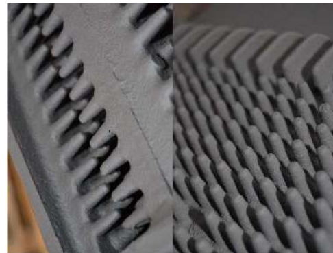
Рисунок 1. Внешний вид поверхностей теплообменника
