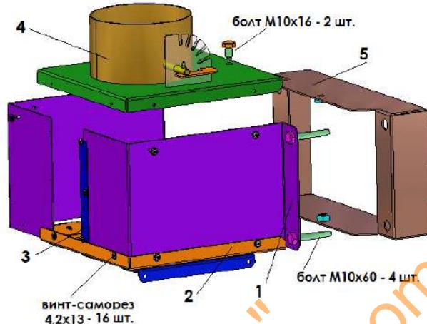
**Рис.4.1** Дымоход котлов КС-Т/Г/ТП -20-20р-20/20S
