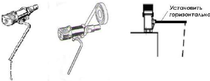
**Рис.10** Схема монтажа устройства регулятор тяги
