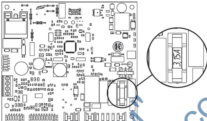
Рис. 13. Расположение предохранителя
