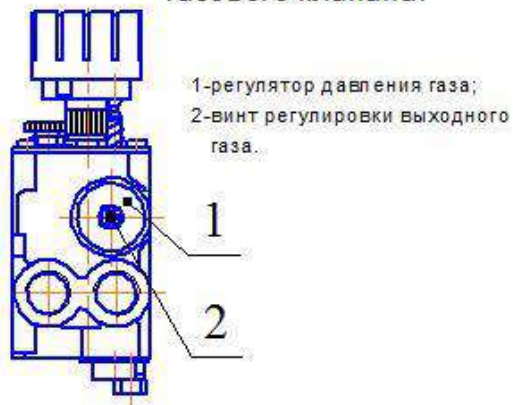
Рис.3А Элементы регулировки газового клапана.
