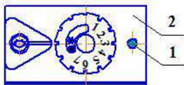
Рис.3А Элементы регулировки газового клапана.
