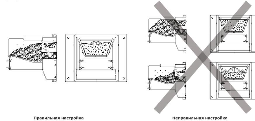
8.6.1.3. Однако при работе котла на мощности меньше  $Q_N$  может наблюдаться снижение уровня топлива в горелке и это будет являться нормой.
