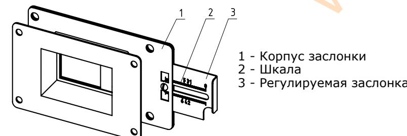
Рис.12 Заслонка вентилятора
