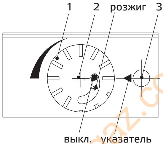
1 — ручка-указатель; 2 — кнопка магнитного клапана; 3 — пьезорозжиг
