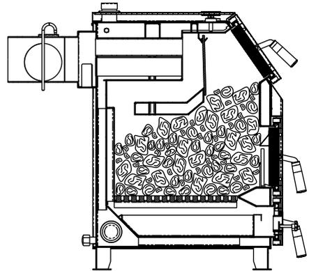
**Рис.4 Заполнение котла топливом для режима длительного горения**
