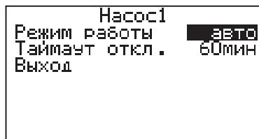
8.11. В меню «Насос1» настраивается режим работы насоса основного контура отопления и время его работы до отключения, при работе в автоматическом режиме. Возможные режимы насоса1:
