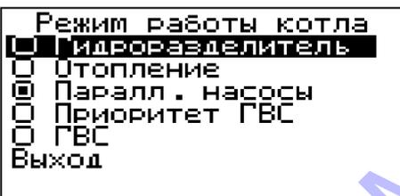
• ГВС: в этом режиме задействован только насос контура ГВС. При достижении заданного значения температуры в бойлере ГВС котел перейдет в режим поддержания горения (🔥). После определенного времени, при отсутствии расхода воды, котел остановится. При снижении температуры в бойлере ГВС котел автоматически запустится.
