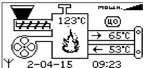
7.3.5. Если в режиме “Пуск/стоп котла” нажать кнопку «ВНИЗ», появляется экран, который позволяет разжечь котел вручную. Если кратковременно нажать кнопку «ВВЕРХ», то на 30 секунд включается подача пеллет для заполнения горелки. Для повтора подачи пеллет также нужно нажать кнопку «ВВЕРХ». Необходимо заполнить горелку до половины и выключить режим заполнения кнопкой «ВНИЗ».
