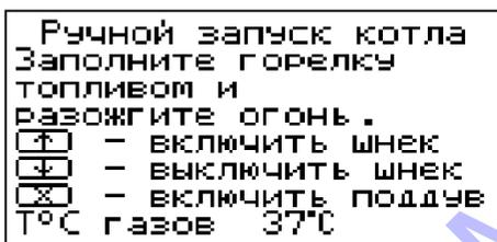
7.3.6. Разожгите пеллеты и включите вентилятор кнопкой «ОТМЕНА». После розжига закройте загрузочную дверцу котла. Температура газов при розжиге котла отображается в нижней строке экрана. При достижении температуры уходящих газов, соответствующей устойчивому горению, котел переключится в режим автоматического горения и на дисплее отображается основной экран котла.
