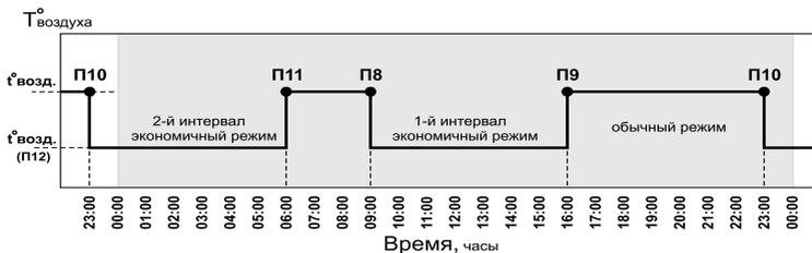
Рис.5 График температуры воздуха в помещении для Режимы 1.
