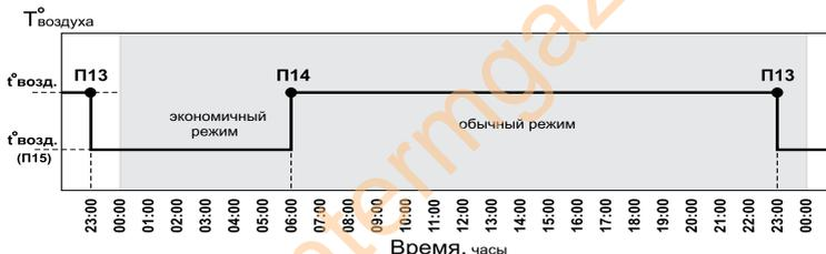
Рис.6 График температуры воздуха в помещении для Режимы 2.
