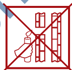
недостаточная тяга (Не используйте котел!)
