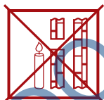
нет тяги (Не используйте котел!)
