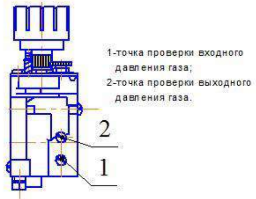
Рис.4А Точки проверки входного и выходного давления газа.
